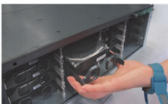
4. Прижмите его до характерного щелчка. Повторите действия для остальных дисков, а затем установите переднюю панель.
